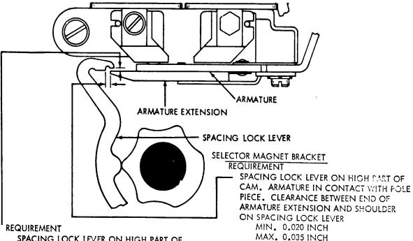
SPACING LOCK LEVER ON HIGH PART OF CAM. ARMATURE IN CONTACT WITH POLE PIECE. SOME CLEARANCE BETWEEN UPPER SURFACE OF ARMATURE EXTENSION AND LOWER SURFACE OF SPACING LOCK LEVER WHEN LOCK LEVER IS HELD DOWNWARD. MAX. 0.003 INCH
